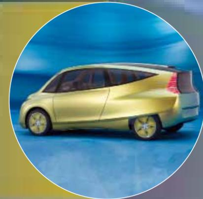
**Ideale Linie:** Der Kofferrfisch schwimmt mit einem sehr niedrigen Strömungswiderstand. Mercedes lehnte sich für die Aerodynamik einer Fahrzeugstudie an diese ungewöhnliche Form an.
