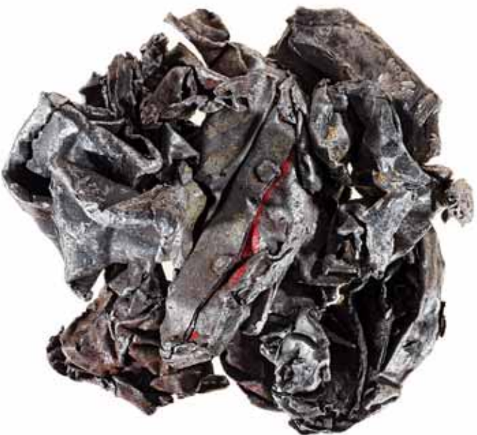
└ Kleine Reste, große Reste: Im Schreddersand stecken viele verschiedene Stoffe – noch muss hierfür die Recycling-Technik weiter optimiert werden (oben). Einfacher ist die Wiederverwendung der beim Schreddern entstandenen Blechstücke – ab damit ins Elektrostahlwerk, wo daraus neuer Stahl wird (unten).
