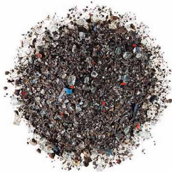
└ Kleine Reste, große Reste: Im Schreddersand stecken viele verschiedene Stoffe – noch muss hierfür die Recycling-Technik weiter optimiert werden (oben). Einfacher ist die Wiederverwendung der beim Schreddern entstandenen Blechstücke – ab damit ins Elektrostahlwerk, wo daraus neuer Stahl wird (unten).
